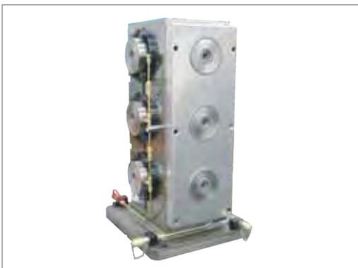
Bloccaggio rapido SPEEDY classic 1 montato e collegato con tubazioni su ciascun lato della torretta di bloccaggio, protetto mediante lamiera (un lato senza lamiera di protezione, in modo che siano visibili le tubazioni).
