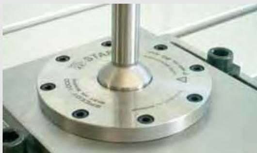
Esempio di posizionamento in base ad una piastra per set 2 SPEEDY
