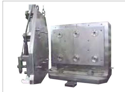
Bloccaggio rapido SPEEDY classic 1 montato e collegato con tubazioni sulla torretta di bloccaggio, protetto da lamiera.
