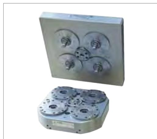
Passaggio fluidi tramite elemento per accoppiamento multiplo con soffiaggio al centro del pallet.
