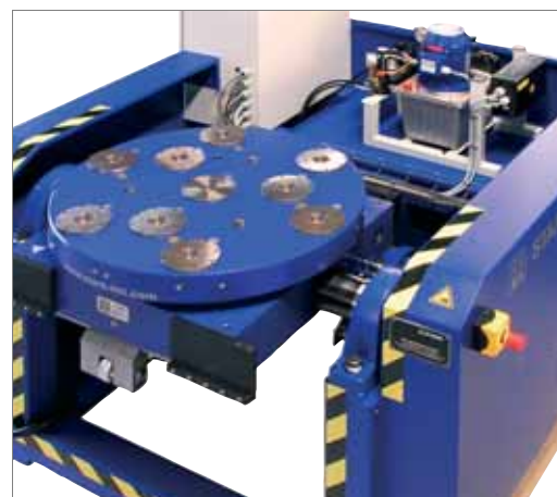
Bloccaggi rapidi SPEEDY classic 2 inseriti in una piastra circolare sulla zona di attrezzaggio.
