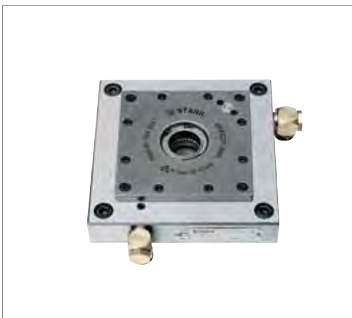
SPEEDY classic 2 con un elemento integrato di passaggio fluidi, ad es. per l'azionamento di una morsa da macchina o di un controllo dell'appoggio.
