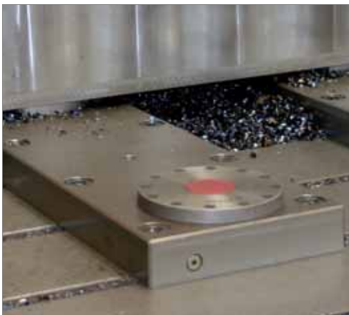
SPEEDY classic 3 - Bloccaggi rapidi inseriti in una piastra di base per squadra angolare.
